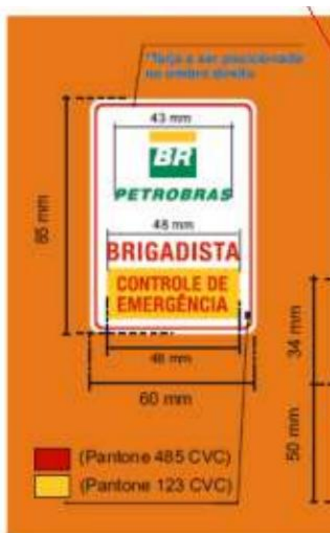
Figura 7 – Identificação de Brigadista (detalhe exclusivo para o Modelo C, sendo a única distinção entre os modelos)
